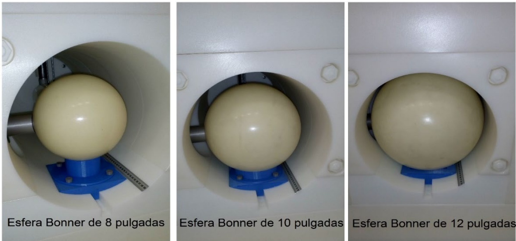
Sistema de esferas Bonner de 2,3,5,8,10 y 12 pulgadas con detector de 6 LiI (LMN-UPM) para realizar la espectrometría
